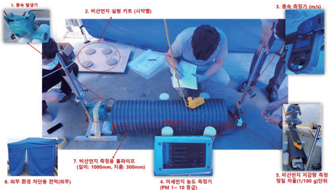
그림 4. 개발비산먼지 저감제의 실내 성능 실험 통한 비산먼지 저감률 분석(참고 : 한국건설순환자원학회 2020 a)
