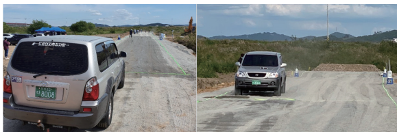
그림 16. 도로 비산먼지 이동측정시스템(인하대학교 환경공학과)
